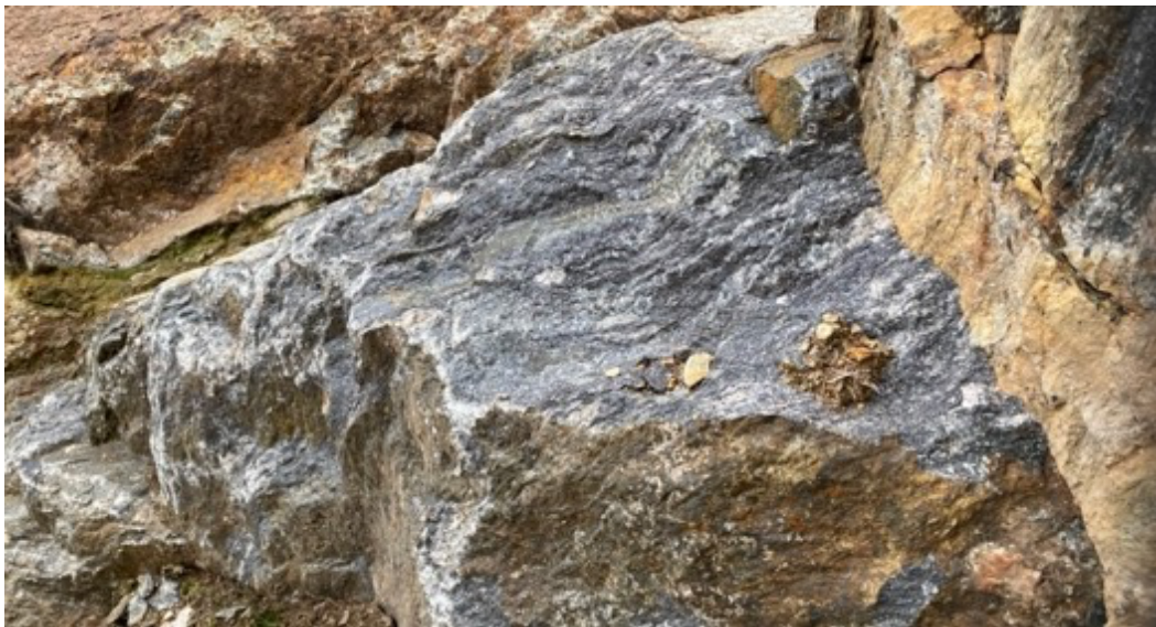
Figur 22 Bilden visar samma berg men med olika typer av vittringsgrad. De rostfärgade områdena är mer vittrade och eftersom rost är ett tecken på sulfidförande mineral så är det lätt att upptäcka. I mitten av bilden har berget nyligen täckts av. Där är det inte alls lika rostigfärgat. Innehållet av sulfider är dock sannolikt lika stort både i de rostiga och i de ovittrade områdena. Nyligen framsprängda bergytter visar mycket sällan tydliga tecken gällande sulfidinnehåll och är därmed svåra att upptäcka. Björklöv som skala.
