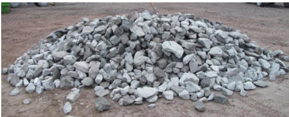
Figur 21 En dammig bergkrosshög. Omöjlig att okulärt kontrollera gällande sulfider. Även om berghögen spolas av kommer överliggande krossbitar dölja de bitar som ligger under.
