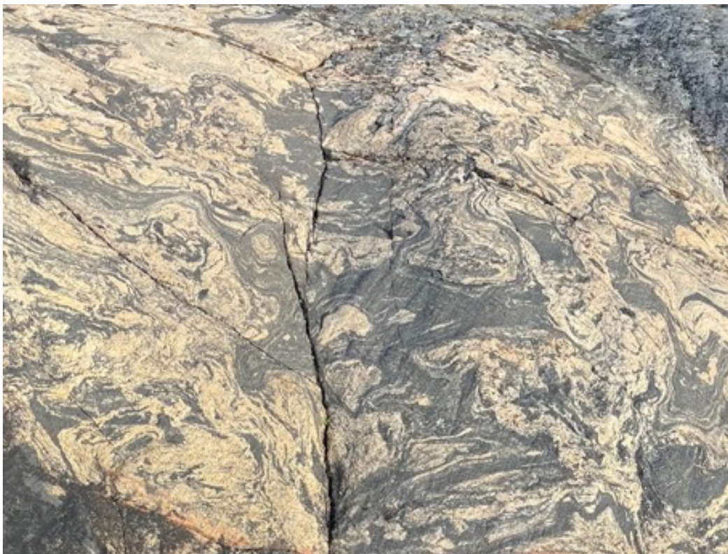
Figur 7 exempelbild på gnejs med komplicerad struktur. De mörka partierna är ofta sulfidförande i olika grad och nästintill omöjliga i detta fall att sortera ut. Ytan på bilden är cirka 1 gång 2 meter.
